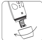
2. Ruotare il coperchio inferiore in senso antiorario per aprire.
