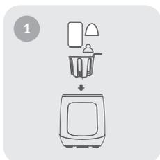
Inserire il portabottiglie all'interno dello scaldabiberon ed immergervi la bottiglia capovolta.
